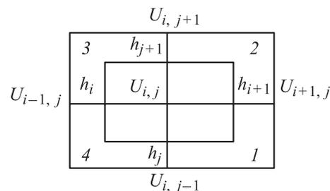
**Рис. 2.** Ячейка (пятиточечная схема) сетки, окружающая внутренний узел.
