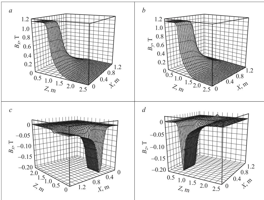
Рис. 5. Пространственное распределение компонент  $B_y$ ,  $B_x$ ,  $B_z$  магнитного поля СП-40 при токе  $I = 600$  А.
