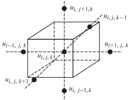
Рис. 3. Элементарная ячейка разностной схемы.
