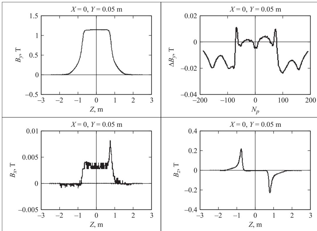
**Рис. 8.** Распределение расчетных и экспериментальных компонент  $B_y$ ,  $B_x$ ,  $B_z$  при фиксированных  $x = 0$ ,  $y = 0.05$  м и разность  $\Delta B_y$  вдоль оси  $Z$ .
