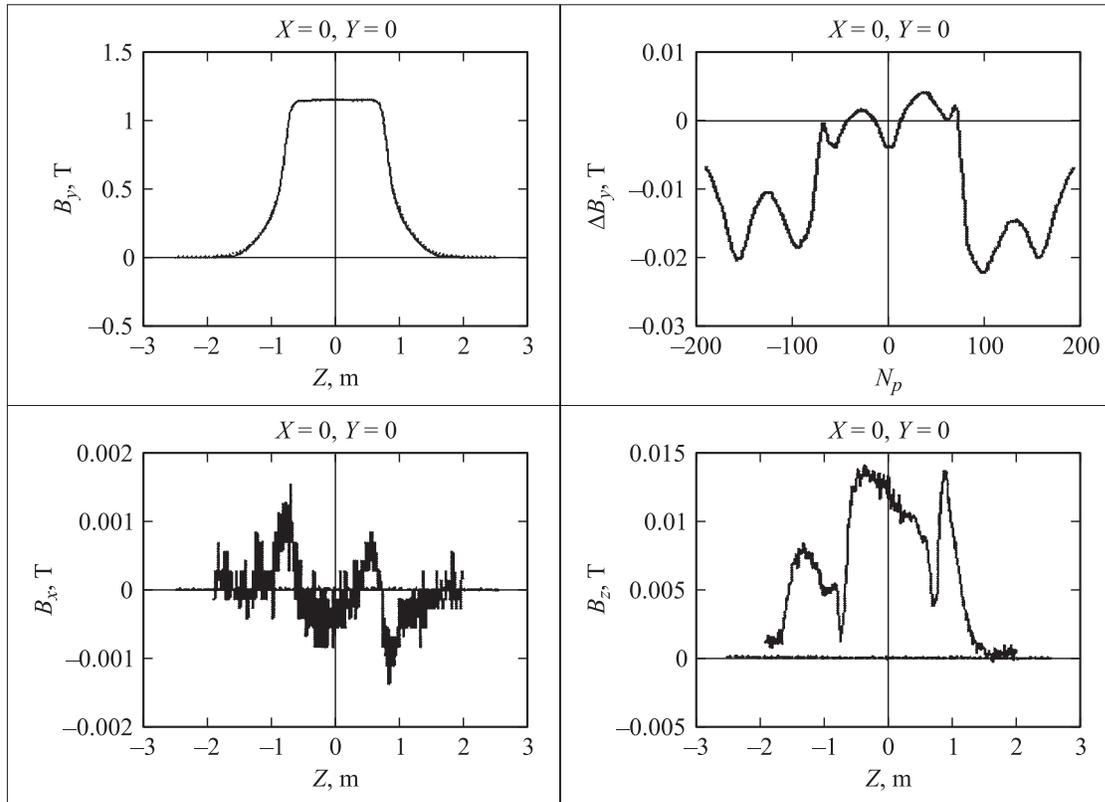
**Рис. 6.** Распределение компонент  $B_y, B_x, B_z$  при фиксированных  $x = 0, y = 0$  м (медианная плоскость, центр магнита) и разность основной компоненты  $\Delta B_y$  вдоль оси  $Z$ .
