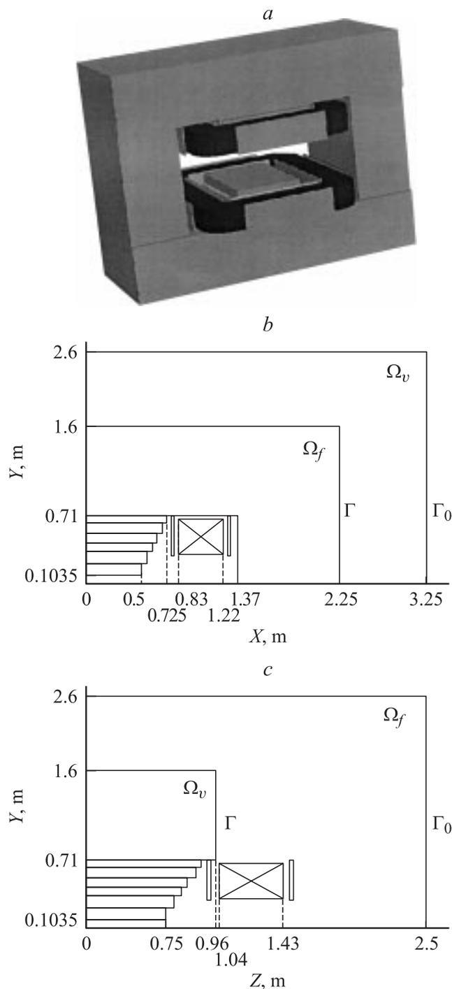
**Рис. 1.** Общий вид спектрометрического магнита СП-40 (а). Расчетная область 1/8 части магнита: разрез в плоскости  $XOY$  (b) и  $YOZ$  (c).
