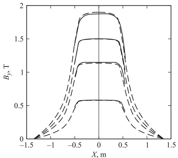
Рис. 4. Расчетная  $B_y$  компонента магнитного поля для  $I = 1100, 800, 600, 300$  А (при фиксированных  $y = z = 0$  м). Сплошные линии — данные измерений.
