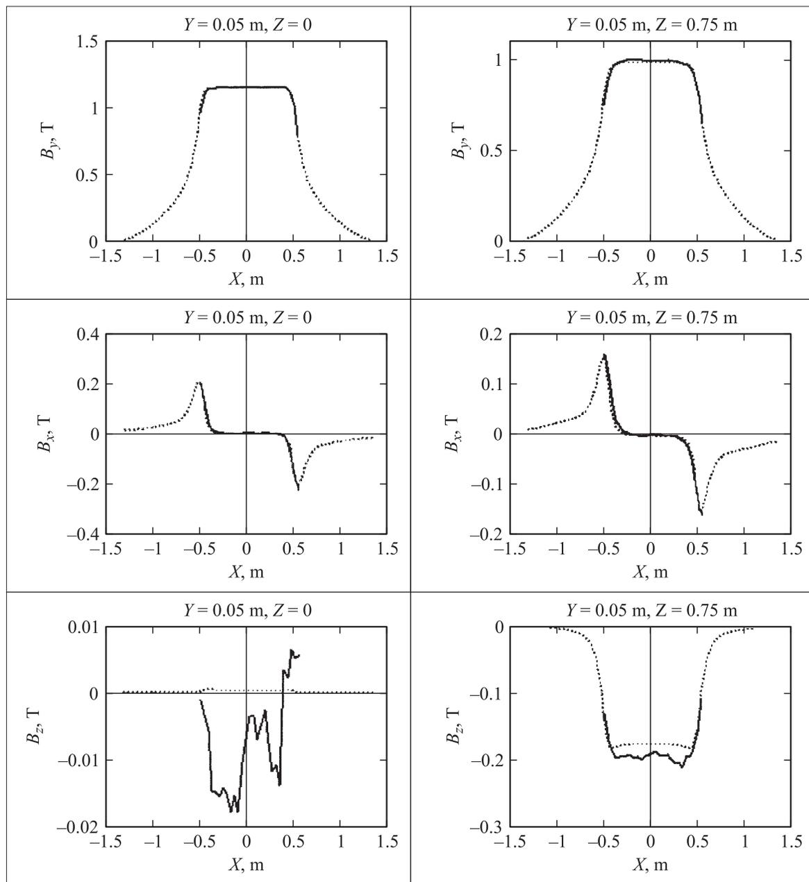
**Рис. 10.** Распределение расчетных и экспериментальных компонент  $B_y$ ,  $B_x$ ,  $B_z$  при фиксированных  $y = 0.05$ ,  $z = 0$  и  $y = 0.05$ ,  $z = 0.75$  m (торец магнита) вдоль оси  $X$ .
