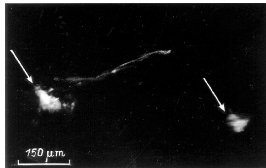
Рис. 1. Два ПВ, состоящие из нитевидных прожилок, расположенные в объеме CaCO 3 . Их толщина в различных точках 0.02–0.04 мм. Помимо показанных на рисунке ПВ кристалл содержит включения с размерами от 5 до 25 мкм.
