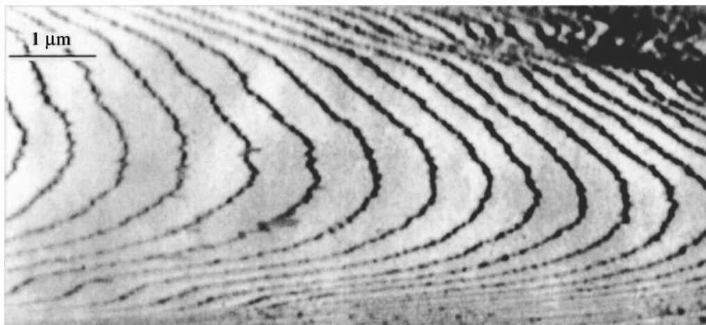
Рис. 2. Типичное изображение ступенчатой поверхности кремния (111) в процессе взаимодействия с кислородом при давлении меньше P_{\text{crit}} . Движение моноатомных ступеней происходило вправо.
