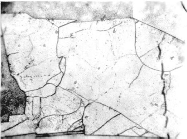
Рис. 1. Мозаичная структура кристалла \text{Cd}_x\text{Hg}_{1-x}\text{Te} . Фотография поверхности, предварительно обработанной селективным травителем; увеличение в 67 раз.
