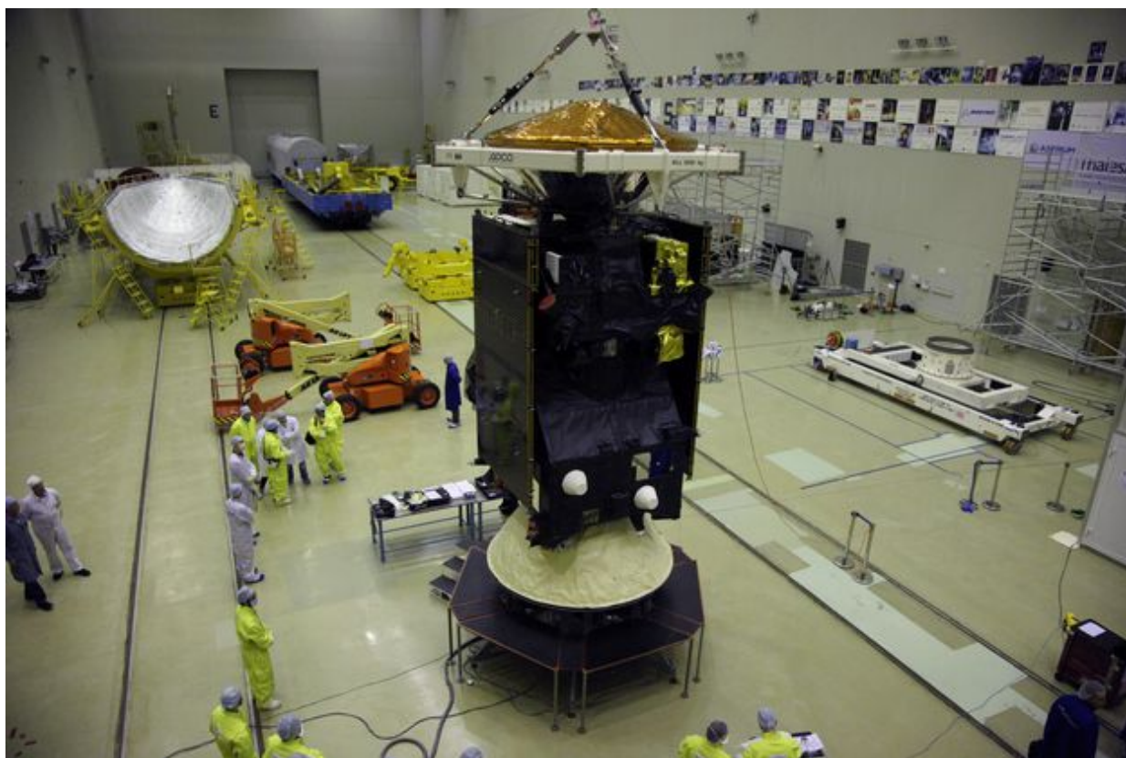
Аппараты миссии «ЭкзоМарс-2016» на Байконуре. Золотое покрытие — экранно-вакуумная теплоизоляция российских приборов АЦС и ФРЕНД (с) ЦЭНКИ
